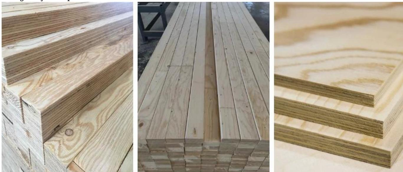
Le mélèze LVL peut être scié, raboté, percé, mortaisé, tenonné, cloué et autres opérations de travail du bois conventionnelles aussi facilement que le bois ordinaire, avec des bords nets et lisses et sans délaminage ni écaillage, ce qui facilite la personnalisation de vos besoins, qu'il s'agisse de créer des formes de meubles complexes ou couper à des dimensions architecturales spécifiques. Le matériau peut être personnalisé pour répondre à vos besoins.
